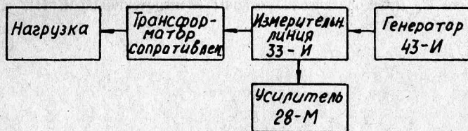
Рис. 7. Схема согласования волновода с нагрузкой посредством трансформатора сопротивлений
